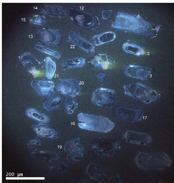
شکل ۱۰ - تصویر کاتدولومینسانس زیرکن‌های بیوتیت‌گرانیت پورفیری (نمونه PG-3)
