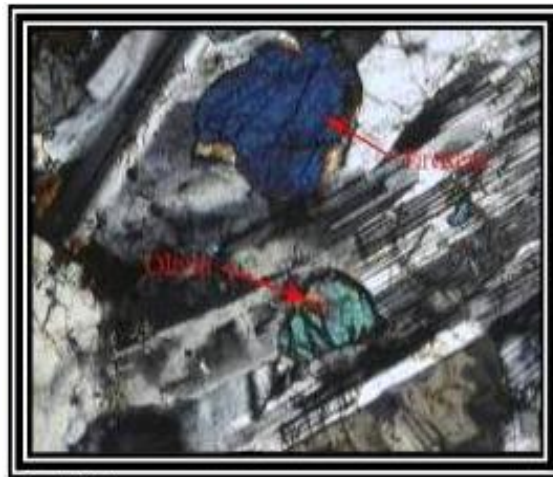
شکل ۵- قرارگیری پویی‌کیلیتیک اولیوین و پیروکسن داخل پلاژیوکلاز در گابروی نوع اول (XPL)
