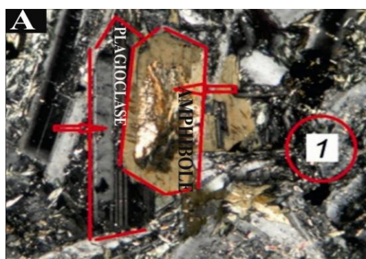
شکل ۲- (A) تصویر میکروسکوپی دیورت؛ (B) تصویر الکترونی (BSE) بخشی از مقطع میکروسکوپی تصویر A که در آن پلاژیوکلاز با ترکیب آندزین (نقاط ۳۰۶ تا ۳۰۸ در جدول ۱) و آمفیبول با ترکیب هورنبلند (نقاط ۳۱۸ تا ۳۲۰ در جدول ۲) مشاهده می‌شود.
