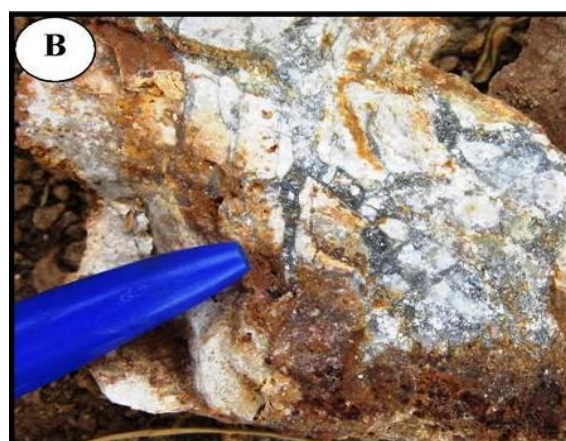
شکل ۶- رگچه‌های موازی و کوارتز برشی شده در منطقه قره‌چیلر و منطقه انیق. (A) رگچه‌های موازی (Sheeted Veinlet) کوارتز در داخل گرانیت پورفیری منطقه قره‌چیلر؛ (B) کوارتز برشی شده سولفیددار (پیریت) و طلادار در حدفاصل بین منطقه قره‌چیلر و منطقه انیق (زبلی‌دره).
