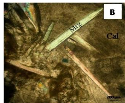
شکل ۵- A) تراکم ریزدانه‌های فلوگوپیت همراه با کلسیت در مرم‌های میکادار (XPL)، B) بلورهای کشیده مارگاریت در زمینه کلسیتی در مرم‌های میکادار (XPL)
