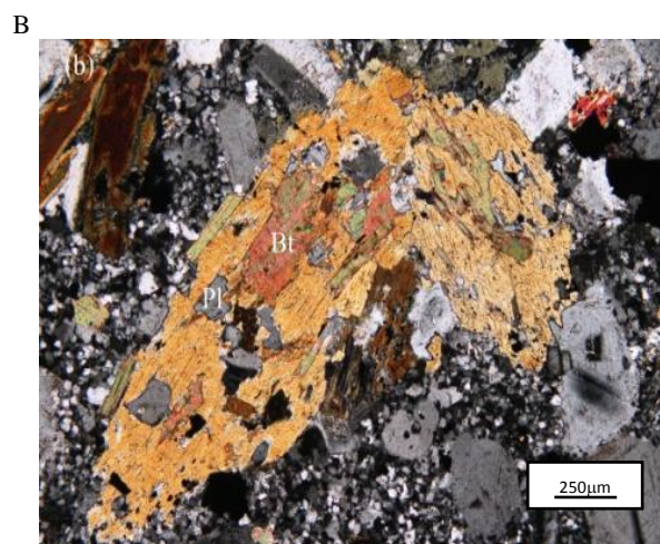
شکل ۷-۷ (A) حاشیه غبارآلود در بلورهای پلاژیوکلاز (XPL)؛ (B) ادخال‌هایی از پلاژیوکلاز و بیوتیت در آمفیبول‌های شرق نابر (XPL)
