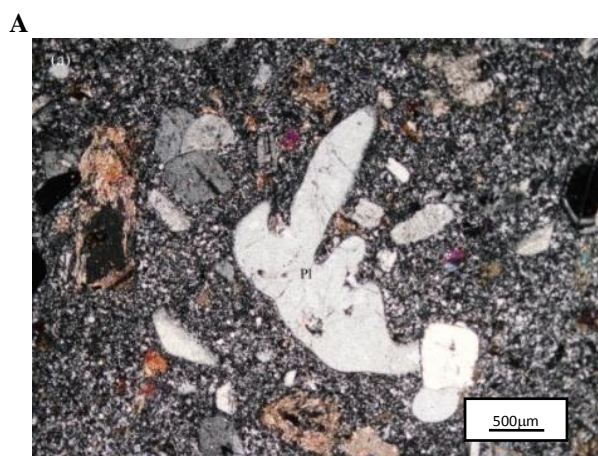
شکل ۴- A) خوردگی شیمیایی به کانی پلاژیوکلاز منطقه شرق نابر شکل آمیبی داده است (XPL)؛ B) جابه‌جایی در ماکل‌های پلاژیوکلاز که در اثر تحمل تنش به وجود آمده است (XPL).
