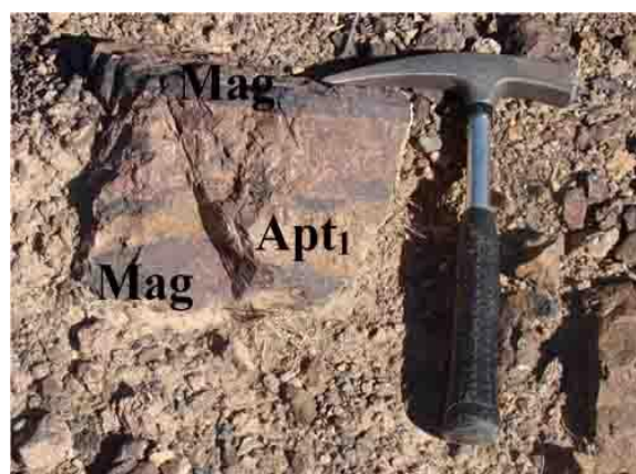
شکل ۸- بافت نواری مگنتیت (Mt) و آپاتیت (Apt) در نمونه دستی در کانسار گزستان.
