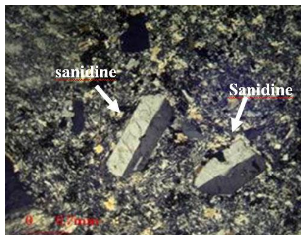
شکل ۵- تصویر میکروسکوپی XPL از فنوکریست‌های سانیدین با ماکل کارلسباد در آلکالی‌ریولیت منطقه اسپیلی (خاور استان گیلان).
