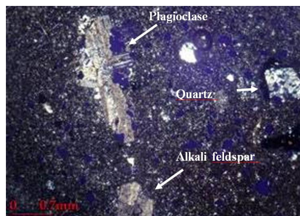
شکل ۶- تصویر میکروسکوپی XPL از بافت آمیگدالوئیدال در تراکی‌آندزیت منطقه اسپیلی (خاور استان گیلان).
