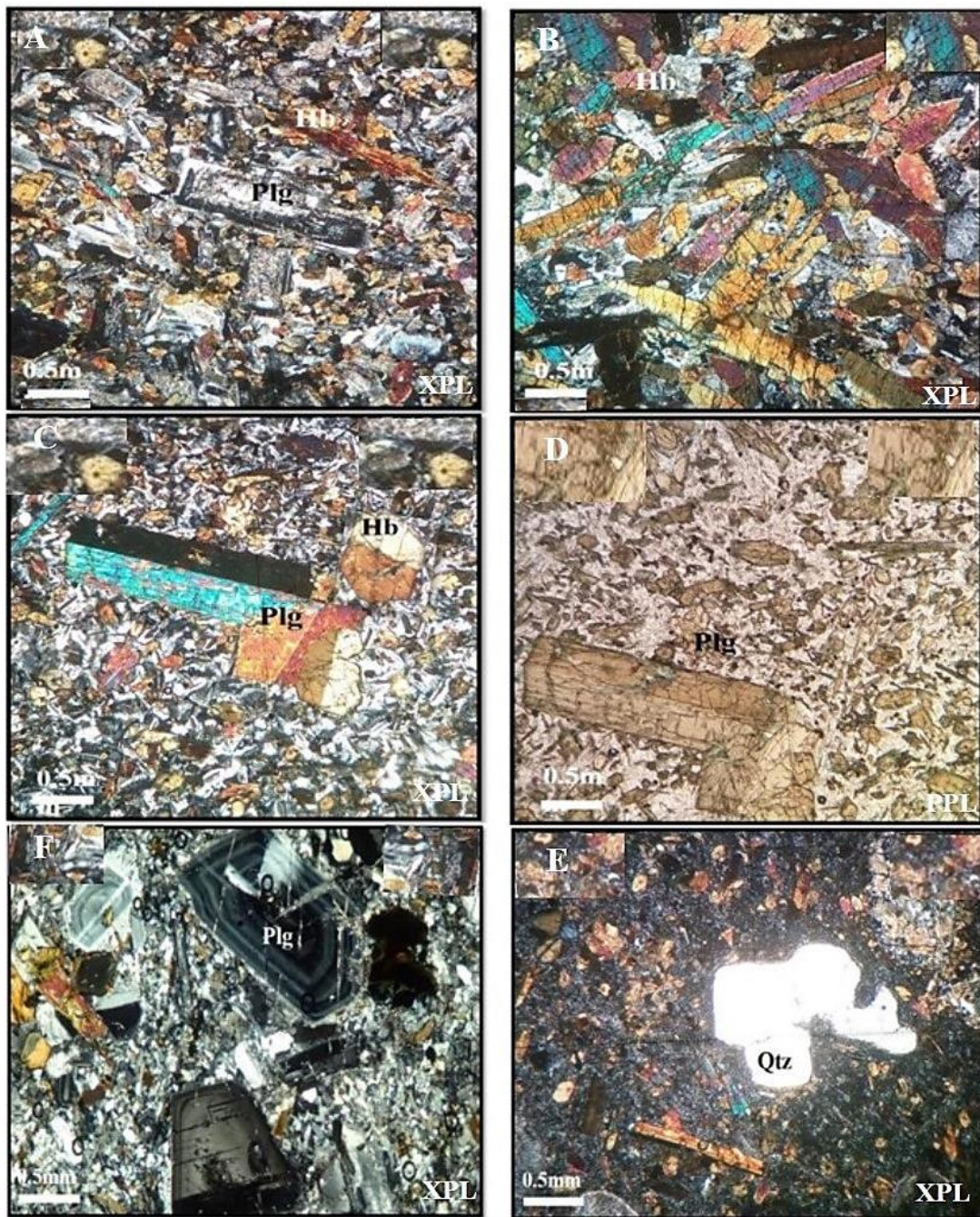
شکل ۴- تصویرهای میکروسکوپی از دایک‌های شمال و باختر زاهدان: (A) درشت‌بلورهای هورنبلند و پلاژیوکلاز و بافت اینترگرانولار در دایک‌های میکرودیوریتی؛ (B) بلورهای هورنبلند با بعدهای گوناگون که بافت انباشتی در دایک‌ها را پدید آورده‌اند؛ (C) مقطع طولی و عرضی کانی هورنبلند؛ (D) برش‌های گوناگون از کانی هورنبلند؛ (E) درشت‌بلور انحلالی و زینوکریست کوارتز در دایک‌های فلسیک آرایش‌یافته؛ (F) درشت‌بلورهای پلاژیوکلاز با منطقه‌بندی (نماد کانی‌ها برگرفته از Kretz (۱۹۸۳) است)
