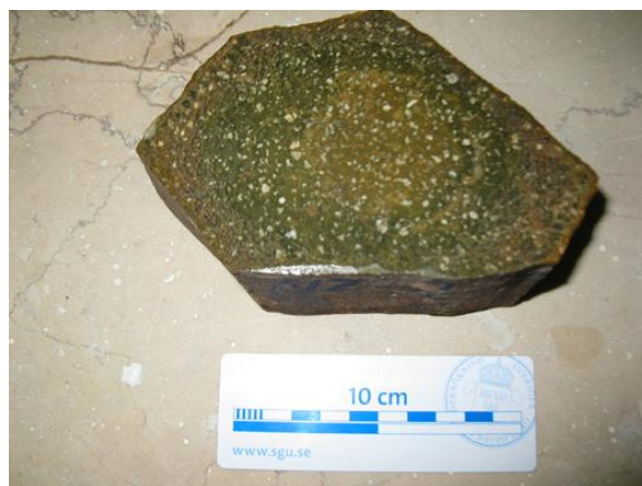
شکل ۵- بافت پورفیریتیک به همراه تغییر رنگ در پی عملکرد متفاوت دگرسانی از کناره‌ها به سوی بخش‌های میانی (در برش عرضی یک درز ستونی ریوداسیتی - داسیتی شش وجهی نامنظم در علیشاهی راین، کرمان)
