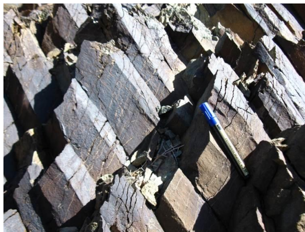
شکل ۳- ساختارهای شیاری (استریا) در درزهای ستونی ریوداسیتی- داسیتی علیشاهی راین (کرمان) (مقیاس = ۱۳/۸ سانتیمتر)
