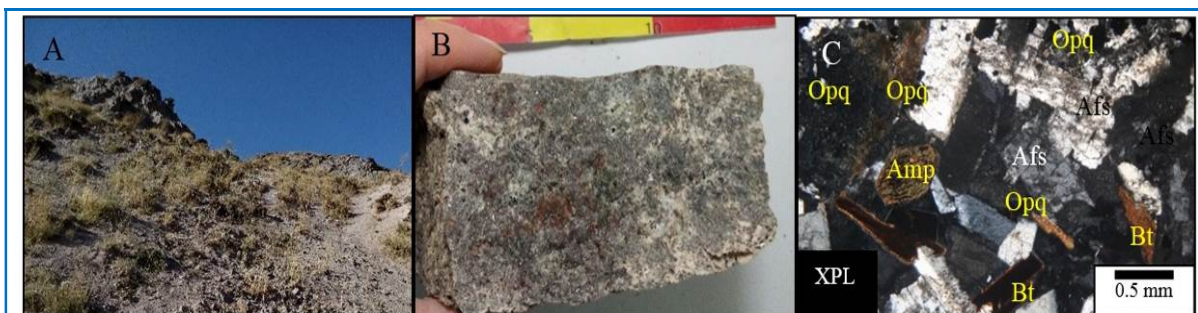
شکل ۱۰.۱A) نمای از مونزوسینیت‌های محدوده مورد بررسی در صحرا. B) آثار اکسیدهای آهن در سطح شکسته‌شده یک مونزوسینیت؛ C) بلور آمفیبول در بین آلکالی‌فلدسپارهای درشت و دگرسان‌شده، بیوتیت و کانی‌های کدر.
