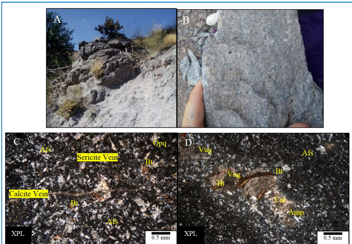
شکل ۵.۵. (A) نمای از تراکیت‌های محدوده کهدلان در صحرا؛ (B) در نمونه دستی با بافت وزیکولار؛ (C) آلکالی‌فلدسپار به همراه کانی‌های کدر و بیوتیت‌های ریزدانه و پراکنده، یک رگچه کلسیتی و یک رگچه سریسیتی در تراکیت؛ (D) آمفیبول دگرسان‌شده در تراکیت کهدلان (Vug: حفره).
